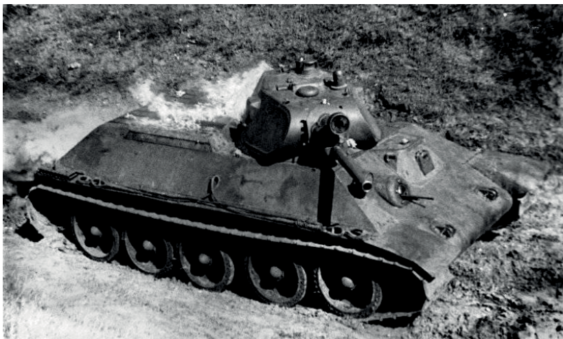
Т-34 на испытаниях: забрасывание моторного отсека бутылками с горючей смесью
