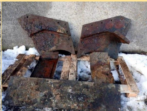
Фрагменты бортовой брони с остатками крепления надгусеничных полок
