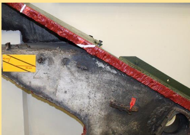
Наклонная броня Т-34 сослужила добрую службу советским танкистам. Рациональные углы наклона всех бортов корпуса и башни приумножили прочность брони, созданной для танков Т-34 и КВ
