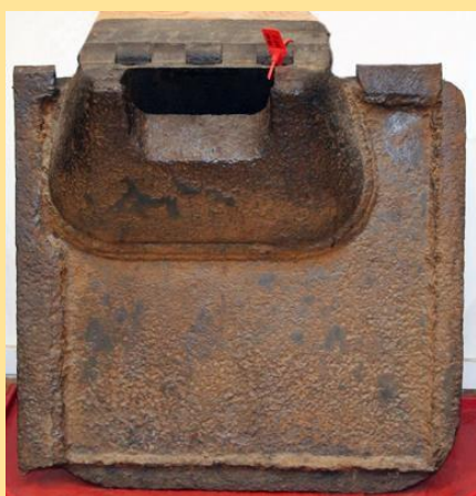
Крышка люка механика-водителя танка Т-34 выпуска 1941 года. Изначально в крышке люка был только один прибор наблюдения без каких-либо броневых иторок.
