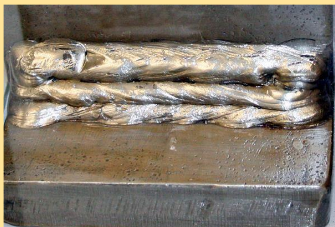
Образец трёхваликового шва автоматической сварки брони, разработанной под руководством академика Е. О. Патона.
